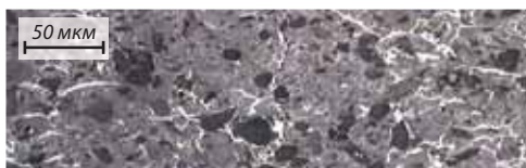
Рис. 3.1. Микроснимок структуры угольного графита, пропитанного сурьмой
