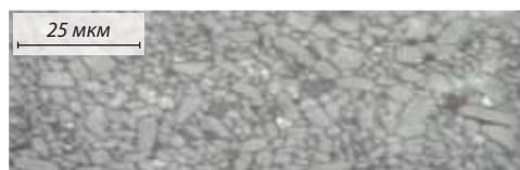
Рис. 3.4. Микроснимок вытравленной поверхности глинозема
