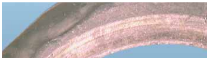
Рис. 5.10. Коррозия связующего вещества вызвала сильную эрозию карбида вольфрама с кобальтом в качестве связующего вещества
