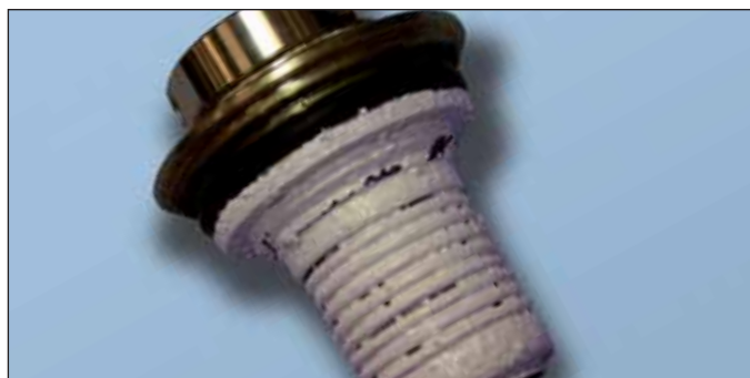
Рис. 5.7. Металлическое сальфонное уплотнение, засоренное скоплением известковой накипи
